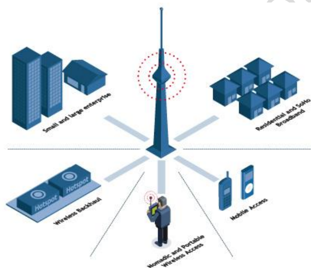
Σχήμα 1.6 Διάταξη ενός τυπικού WMAN
