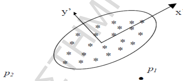
Εικόνα 3.3.ii.β Πλεονέκτημα της προσέγγισης που βασίζεται στον υπολογισμό της απόστασης Mahalanobis. Πηγή: Lazarevic A. et al. (2003)
