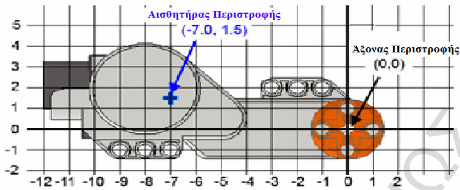
Εικόνα 2-39: Παρουσίαση κινητήρα κίνησης του Lego Mindstorms Nxt Robot στο καρτεσιανό επίπεδο[8]
