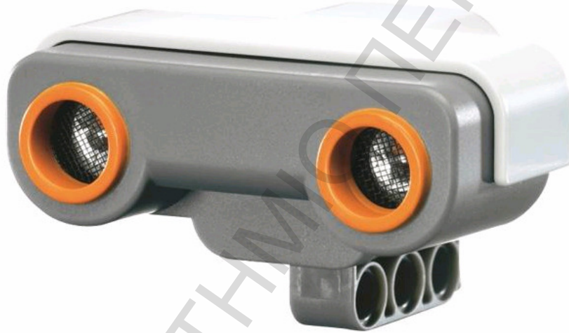
Εικόνα 2-37: Παρουσίαση αισθητήρα υπέρηχων
