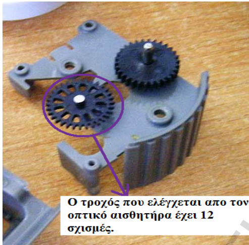
Πίνακας 2-6: Παρουσιάζει το συνολικό αριθμό του λόγο οδόντων (gear ratio) ενός μοτέρ
