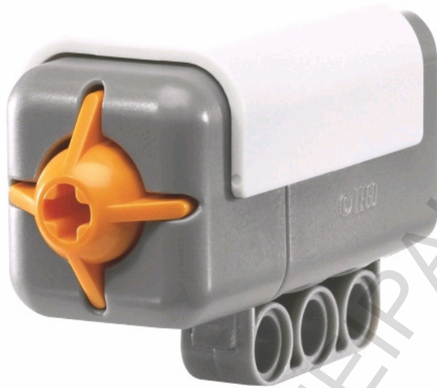
Εικόνα 2-29: Παρουσίαση του αισθητήρα αφής
