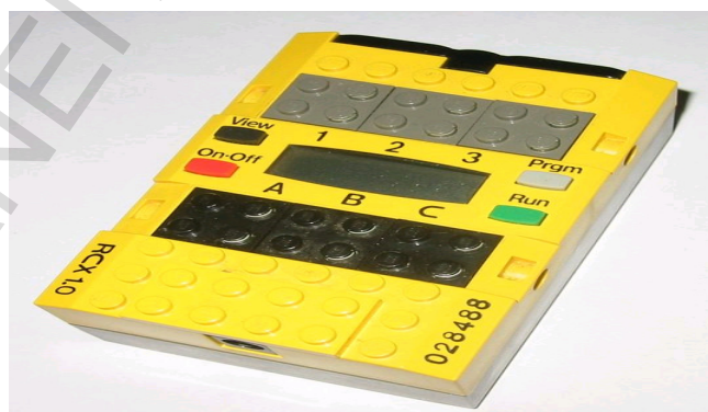
Εικόνα 1-5: : Robotic Control Explorer (RCX) πρώτης γενιάς προγραμματιζόμενο από το χρήστη [19]
