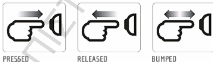
Εικόνα 2-30: Αρχή λειτουργίας αισθητήρας αφής[3]
