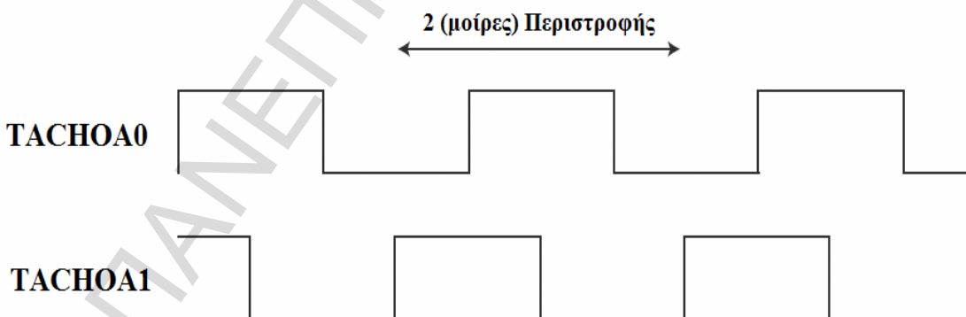
Σχήμα-11. Τετραγωνικοί παλμοί έτσι ώστε το μοτέρ να κινηθεί "πρός τα πίσω"
