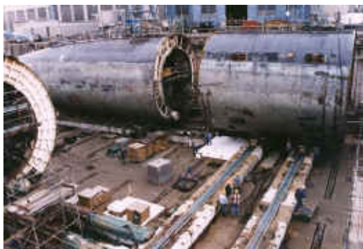
Εικόνα 26: Το διαμέρισμα του αντιδραστήρα έχει αποκοπεί από την άτρακτο (Puget Sound).
