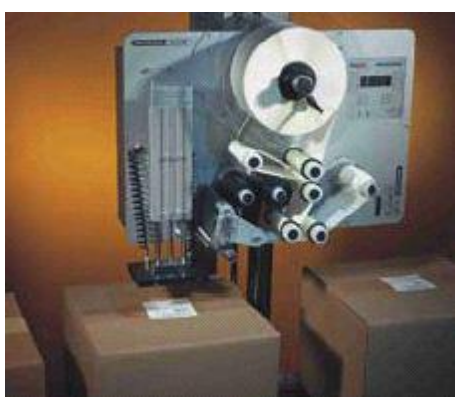
Εικόνα 2.10 Αυτόματη εκτύπωση και επικόλληση ετικετών
