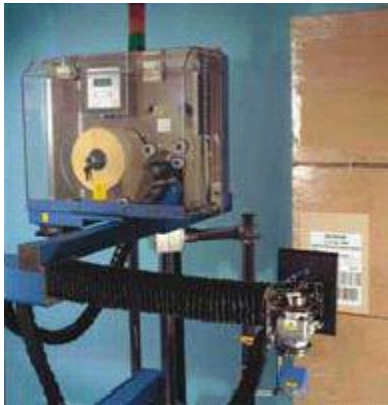
Εικόνα 2.11 Online εκτύπωση και επικόλληση ετικετών παλετών
