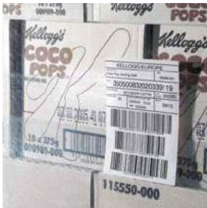
Εικόνα 2.12 Offline εκτύπωση και επικόλληση ετικετών παλετών
