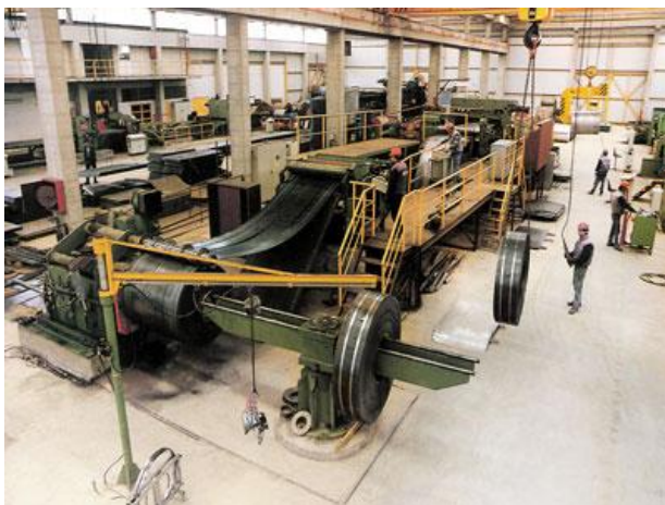
Εικ. 5.3.1 Μονάδα Σχιστικών Μηχανημάτων
