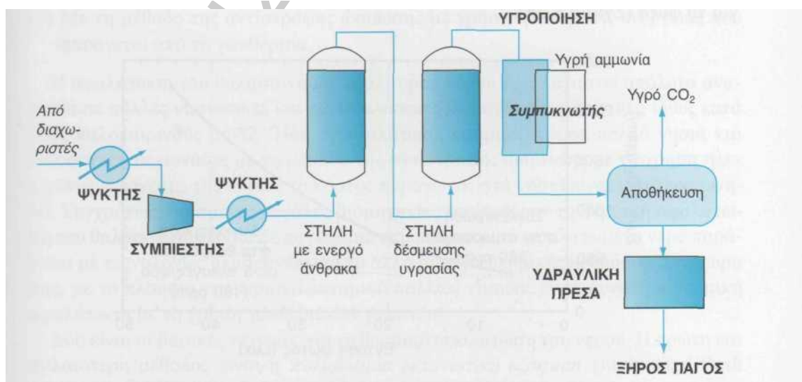
Σχήμα 3.12: Διαδικασία ανάκτησης διοξειδίου του άνθρακα, πηγή: Νικόλαος Β. Ανδρίτσος-Μιχάλης Δ. Φύτικας, «Γεωθερμία», 2004
