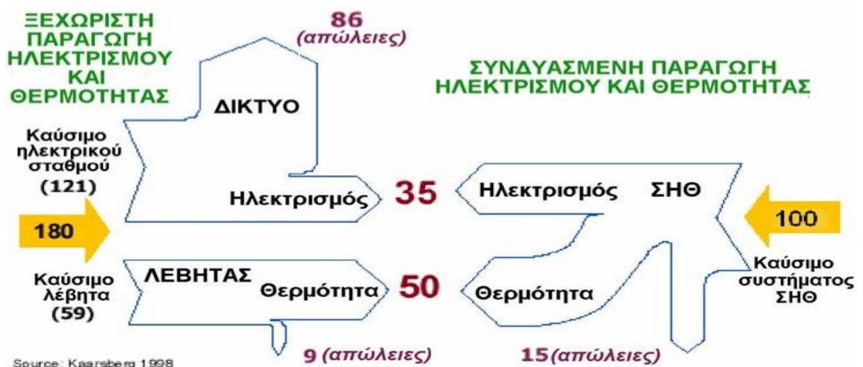
Σχήμα 1.1 Σύγκριση συμβατικού συστήματος με σύστημα συμπαραγωγής
