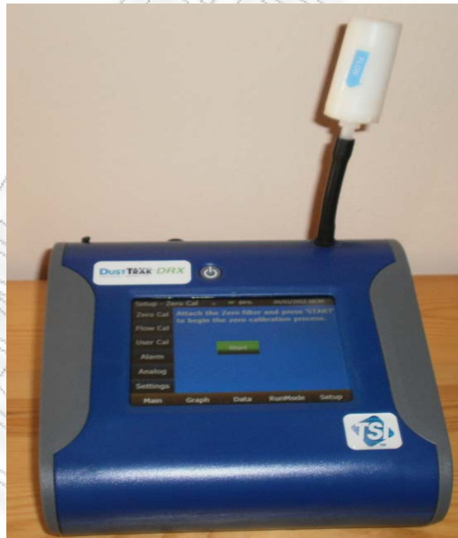
Εικόνα 5.3. Το όργανο μέτρησης DustTrak με το zero filter για την επίτευξη της βαθμονόμησης .
