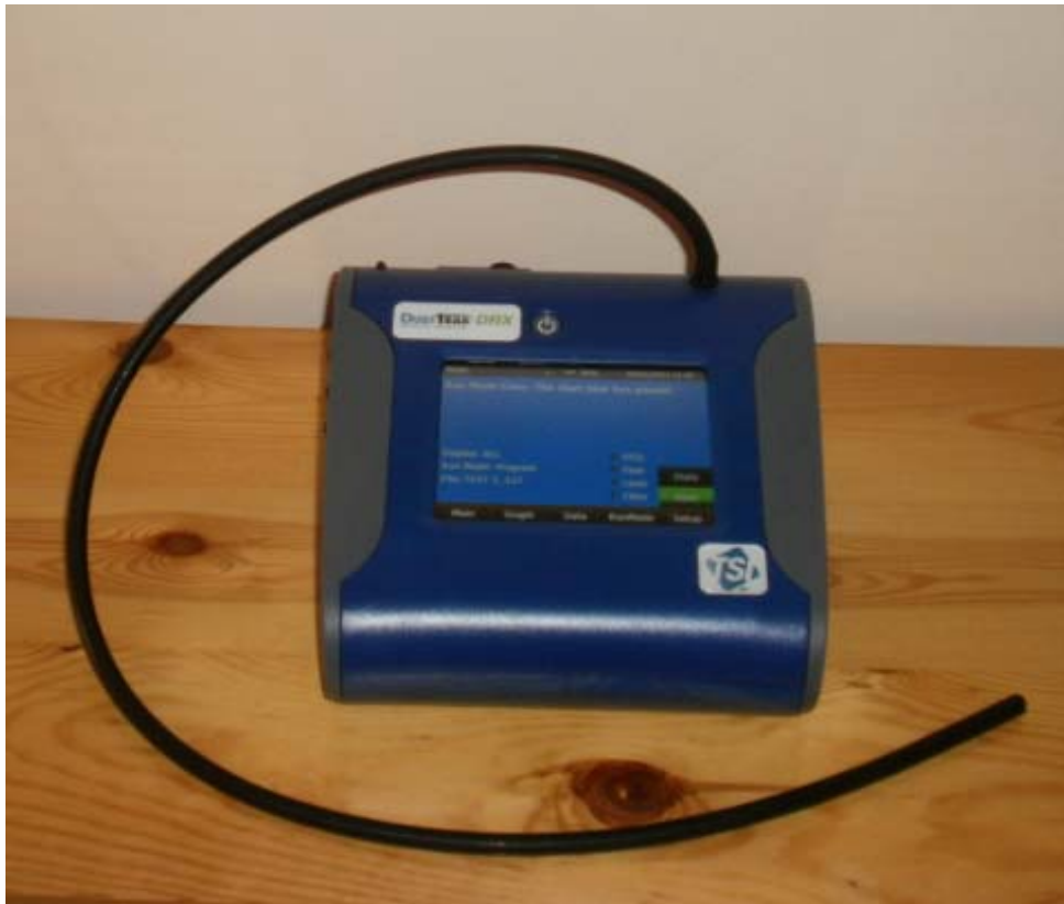
Εικόνα 5.2. Το όργανο μέτρησης DustTrak με τον σωλήνα μέσω του οποίου έγινε η είσοδος των σωματιδίων.
