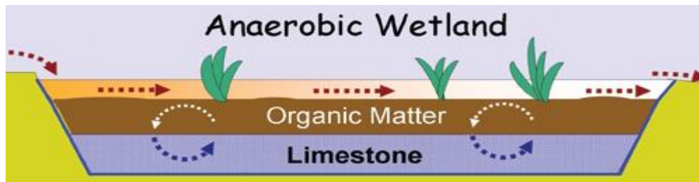
Σχήμα 9: Σχηματική αναπαράσταση αναερόβιου υγρότοπου.
