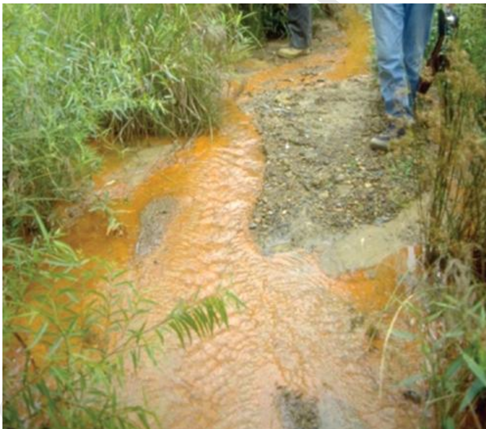
Εικόνα 3: ΟΑΜ που δημιουργήθηκε σε ένα εγκαταλελειμμένο ανθρακωρυχείο. Το πορτοκαλί χρώμα οφείλεται στον σίδηρο που έχει αρχίσει να ελευθερώνεται λόγω της οξείδωσης του σιδηροπυρίτη που λαμβάνει χώρα σύμφωνα με την αντίδραση 2.1.
