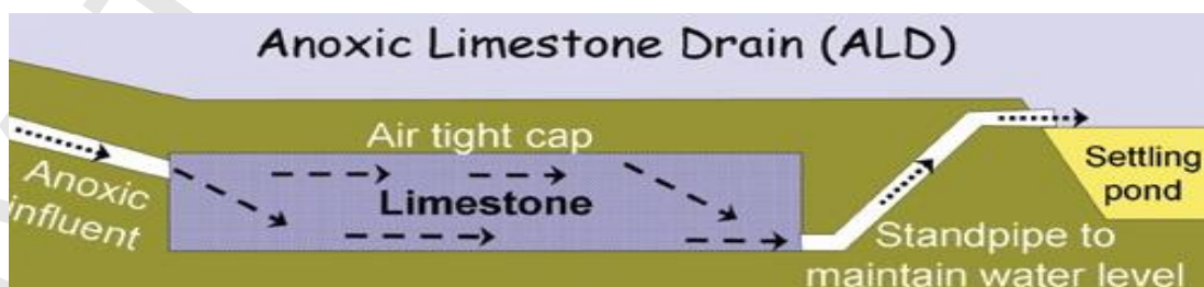
Σχήμα 10: Σχηματική αναπαράσταση Ανοξικής Ασβεστολιθικής Τάφρου.
