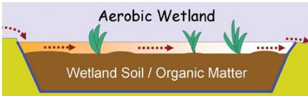
Σχήμα 8: Σχηματική αναπαράσταση αερόβιου υγρότοπου.
