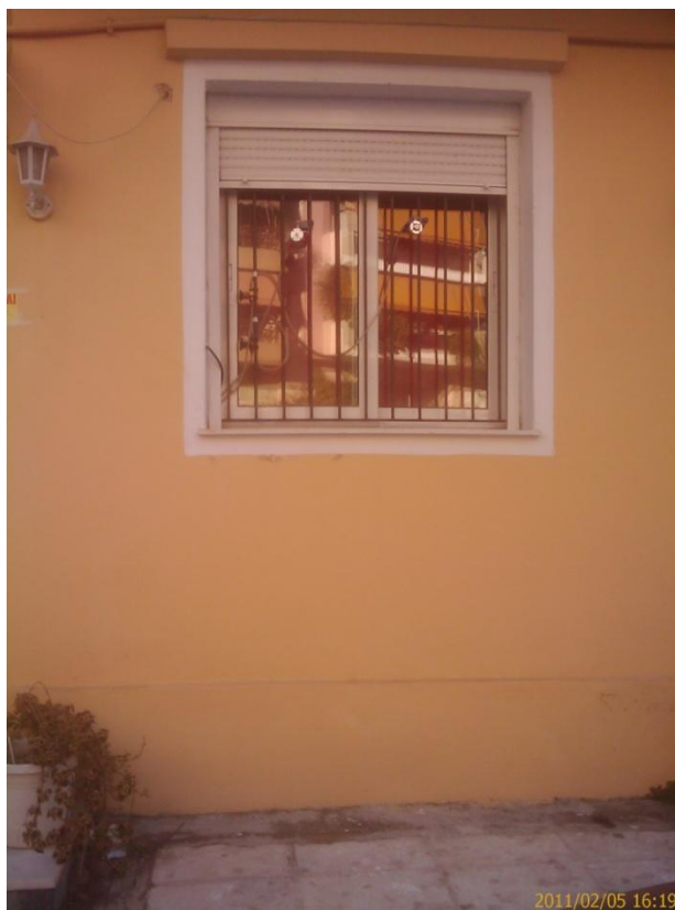
Εικόνα 9.9: Τα όργανα στο χώρο δειγματοληψίας. Κάτω αριστερά στο παράθυρο διακρίνεται το inlet του Dust Trak, πάνω αριστερά το Harvard PEM για τα PM_{2.5} και πάνω δεξιά το Harvard PEM για τα PM_{10} . Η απόσταση τους από το έδαφος ήταν 1.88m, 2.21m και 2.24m αντίστοιχα.
