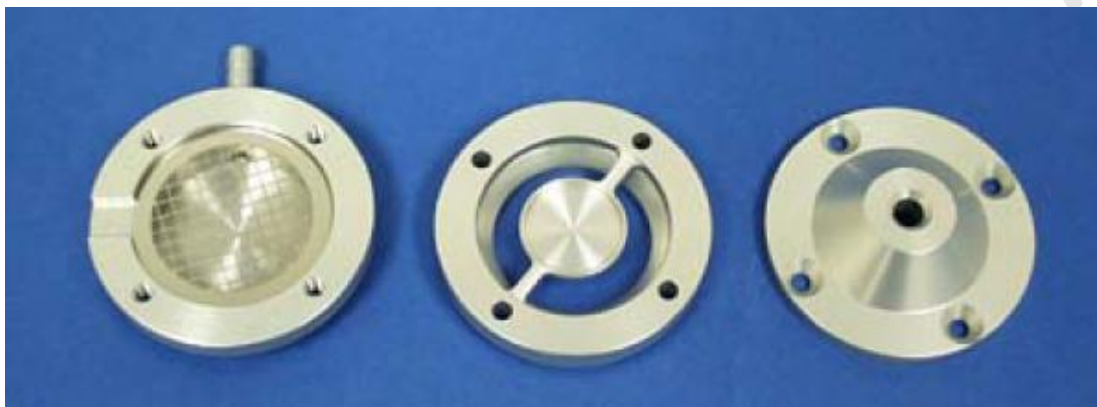
Εικόνα 9.13: Βάση με μεταλλικό πλέγμα, impaction plate και η κεφαλή των Harvard PEMs.
