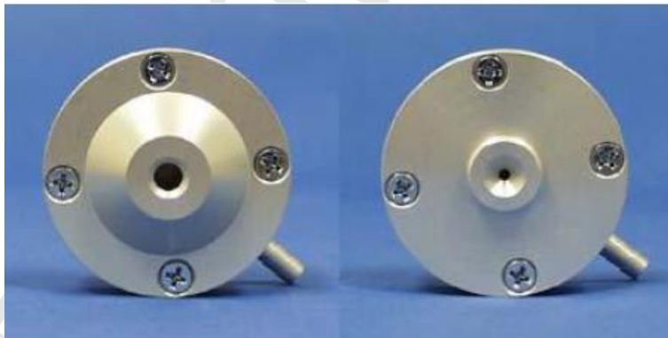
Εικόνα 9.12: Οι δειγματολήπτες Harvard PEMs για σωματίδια PM_{10} και PM_{2.5} αντίστοιχα.
