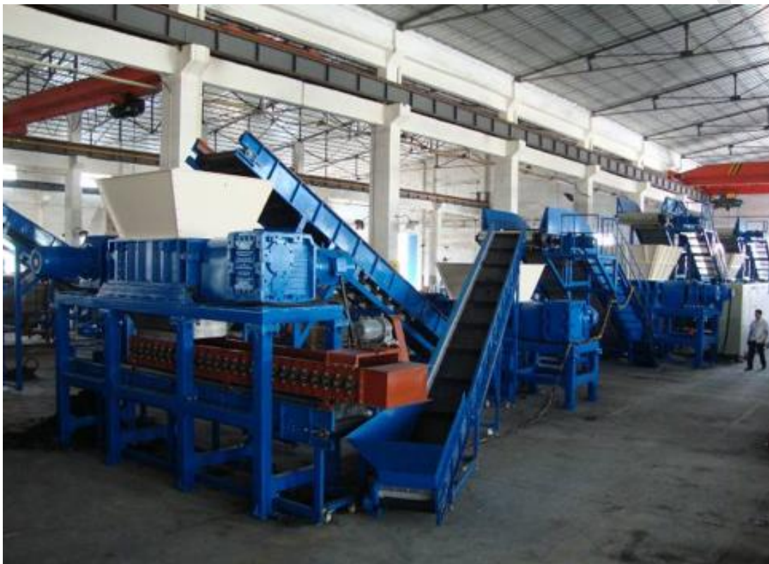
Εικόνα 4.3. Τεμαχιστές στη γραμμή παραγωγής σε σειρά για επανεπεξεργασία των κλασμάτων (Πηγή: http://www.globalrecyclingequipment.com/ ).
