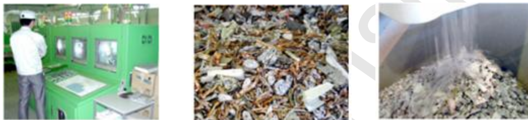
Εικόνα Α.12. Διαχωρισμός χάλυβα και αφρού από ουρεθάνη.
