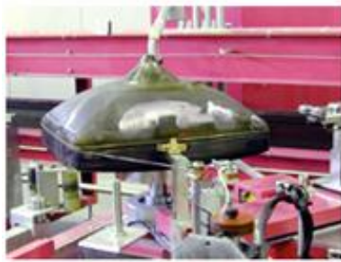
Εικόνα Α.6. Αποσυναρμολόγησή καθοδικού σωλήνα ακτινών 2 ο βήμα.
