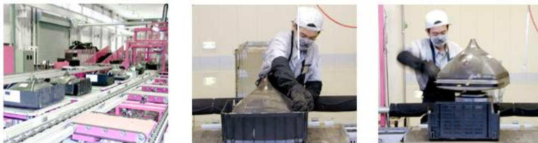
Εικόνα Α.4. Εξαγωγή καθοδικού σωλήνα ακτινών (cathode ray tube).
