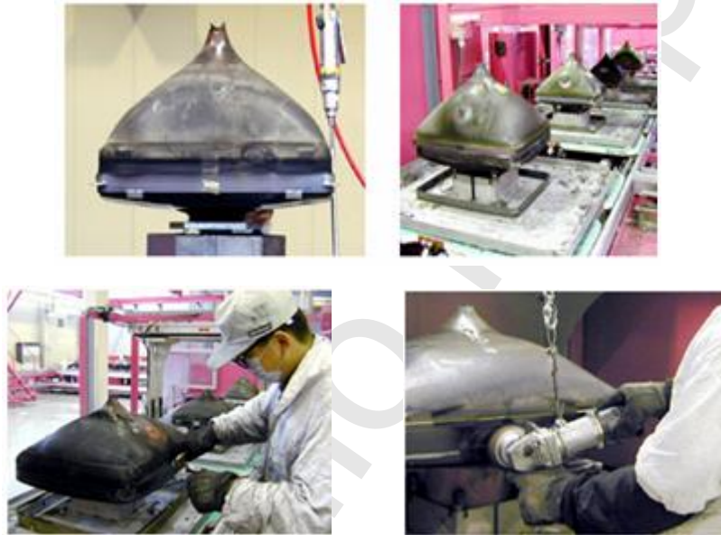
Εικόνα Α.5. Αποσυναρμολόγησή καθοδικού σωλήνα ακτινών 1 ο βήμα
