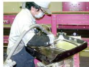
Εικόνα Α.8. Απομάκρυνση επιστρώσεων αργιλίου από το εσωτερικό του γυαλιού της οθόνης .
