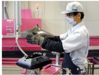
Εικόνα Α.7. Αποσυναρμολόγησή καθοδικού σωλήνα ακτινών 3 ο βήμα.
