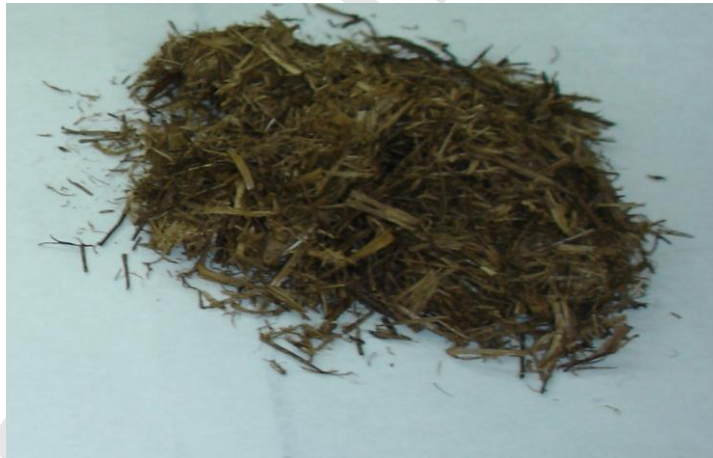
Σχήμα 5.1: Άχυρο τροποποιημένο με τη διαδικασία της αυτοϋδρόλυσης.
