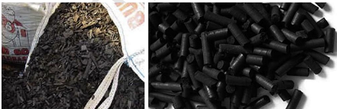
Σχήμα 1.3: Κατεργασμένα ροκανίδια ξύλου πριν την πελλετοποίηση (pelletisation) (αριστερά) και σε μορφή pellets δεξιά
