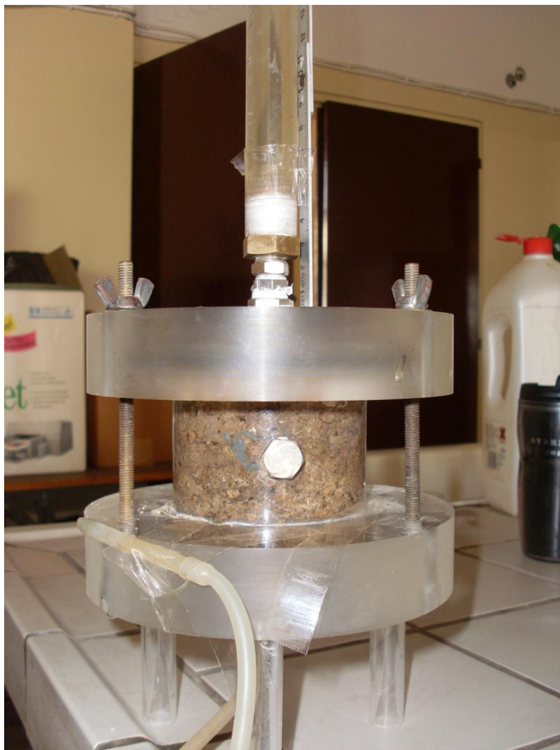
Εικόνα 14: Περατόμετρο μεταβλητού φορτίου
