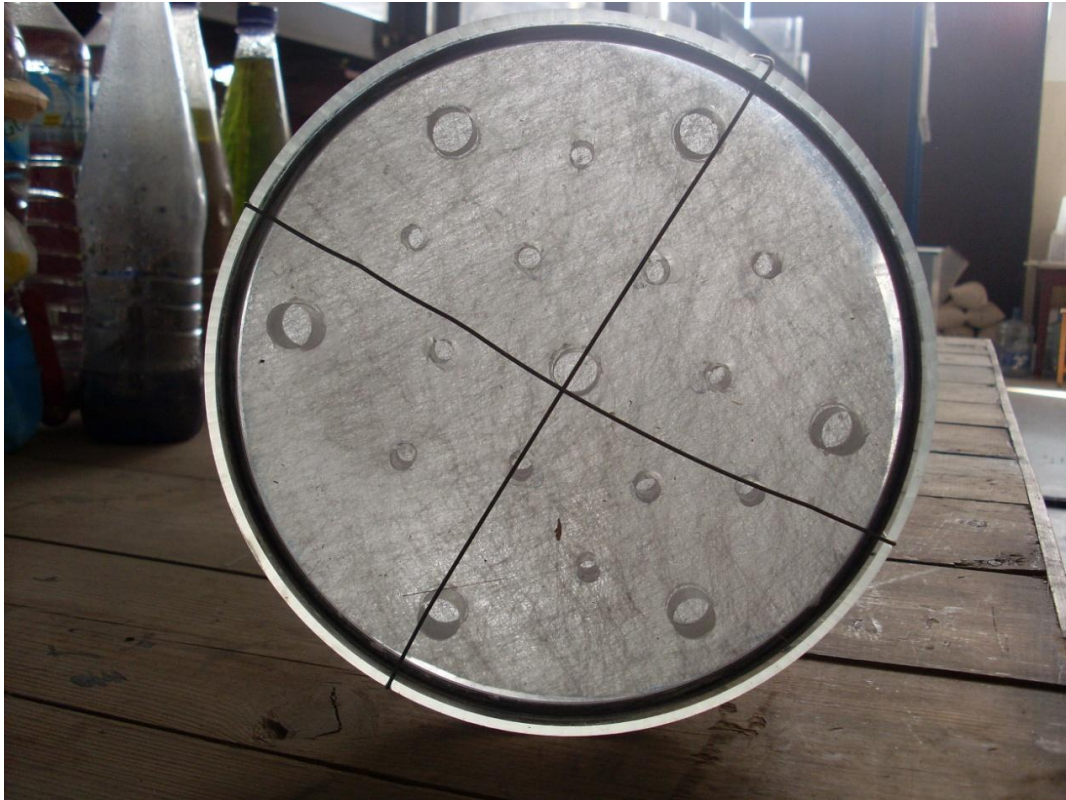
Εικόνα 12: Διάτρητο πώμα και γεωμεμβράνη του λυσιμέτρου
