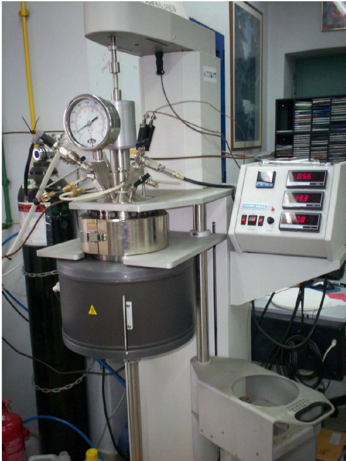
Εικόνα 4.2: Εικόνα του αυτόκλειστου όπου διακρίνονται το δοχείο, η βάση του δοχείου και ο θερμαντικός μανδύας που περιβάλλει το δοχείο.
