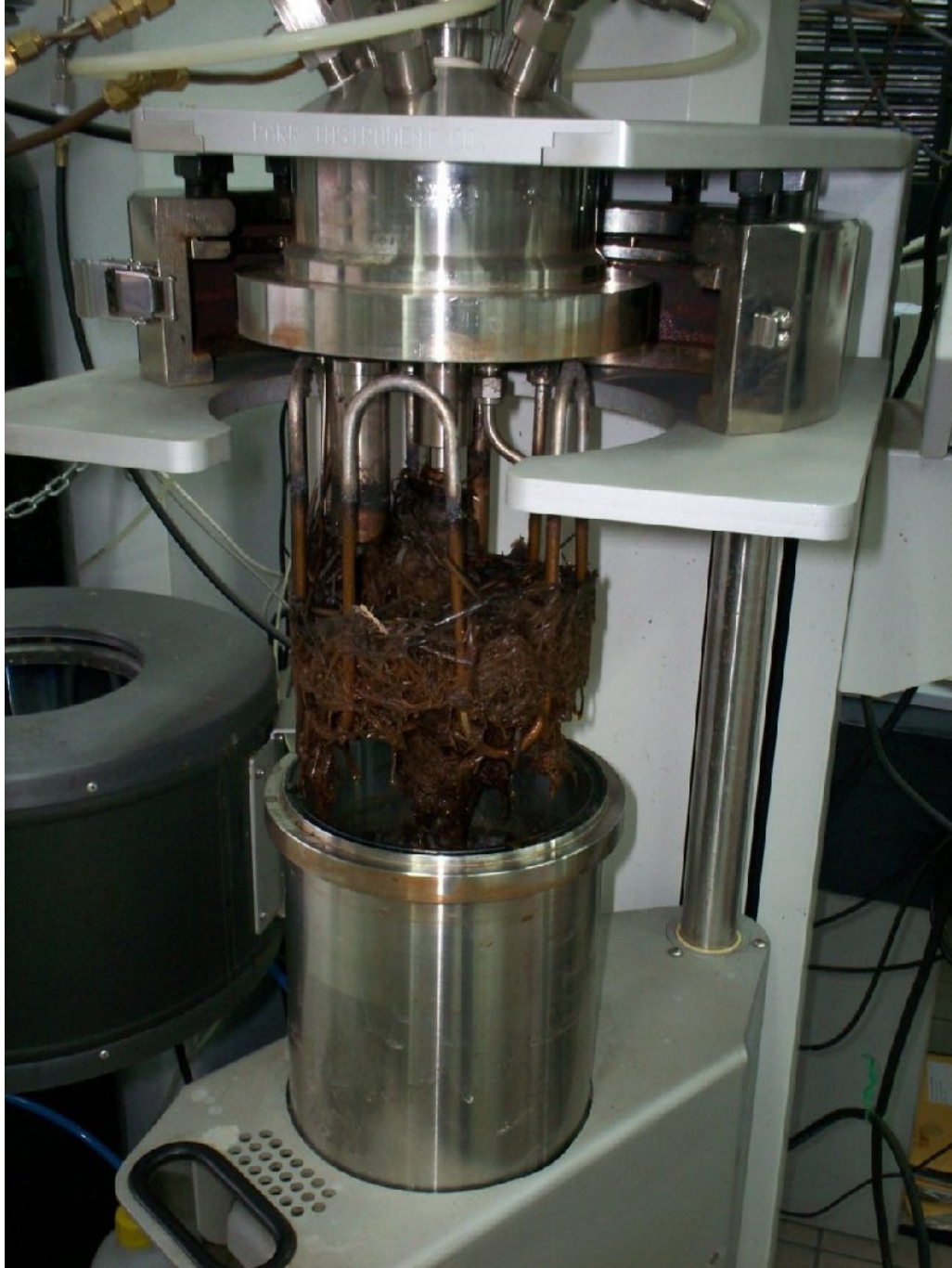
Εικόνα 4.3: Εικόνα του αυτόκλειστου αμέσως μετά το τέλος της αντίδρασης. Διακρίνεται το ανοιχτό δοχείο εντός της βάσης του και το δείγμα άχυρου που έχει υποστεί αντίδραση.
