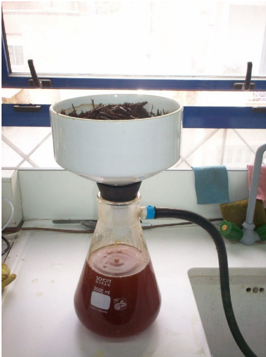
Εικόνα 4.4: Ηθμός Buchner όπου γίνεται η διήθηση του υλικού. Παρατηρείται ο σωλήνας υποπίεσης ο οποίος βοηθάει στην επιτάχυνση της διαδικασίας.
