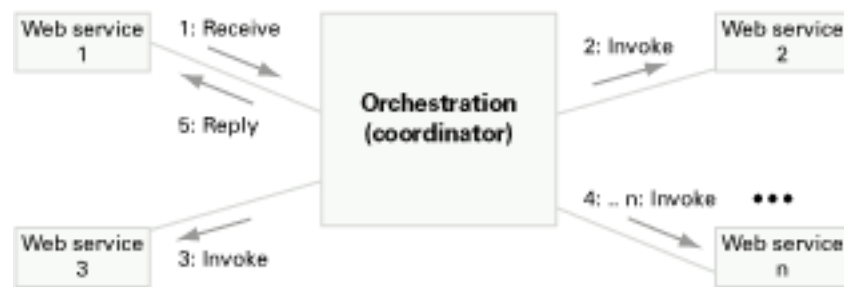
Σχήμα 24: Σύνθεση υπηρεσιών με ενορχήστρωση (Πηγή: Juric M. B., n.d)
