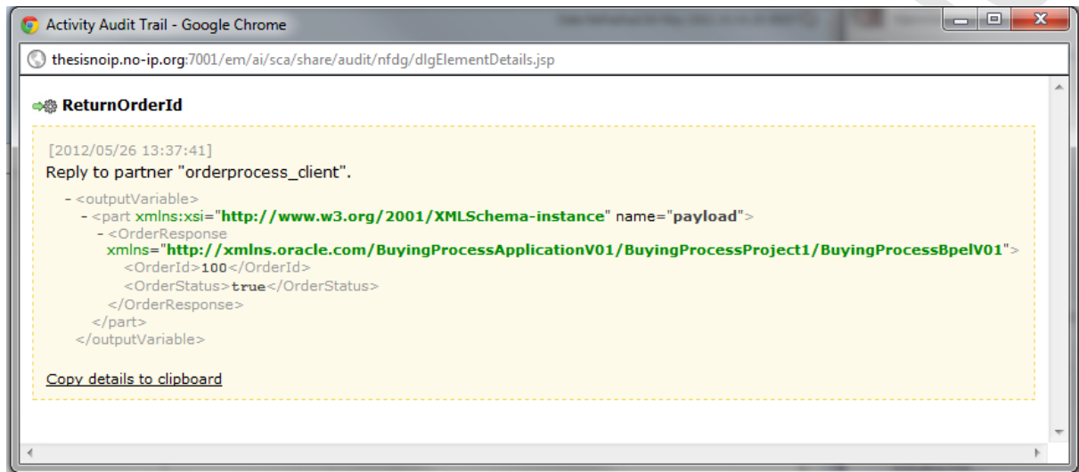
Σχήμα 43: BPEL Engine message Output ReturnOrderId
