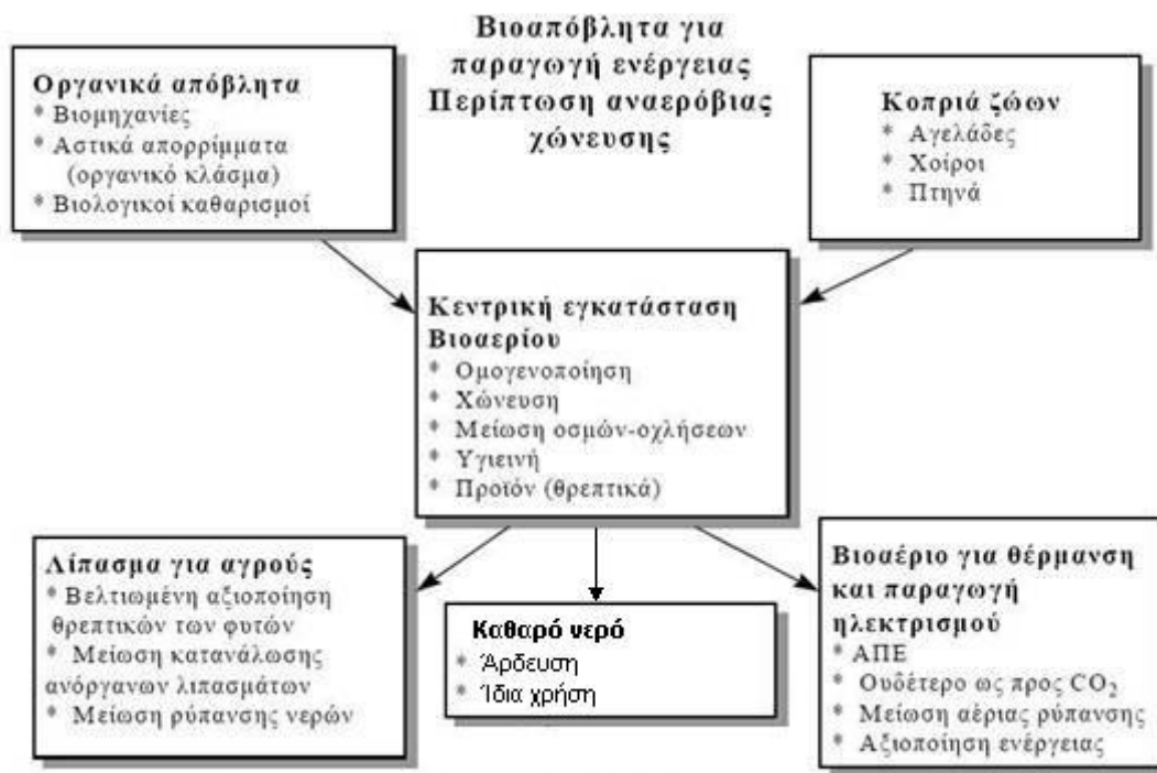
Διάγραμμα 5.1 : Διάγραμμα ροής ολοκληρωμένης επεξεργασίας βιοαποβλήτων.
