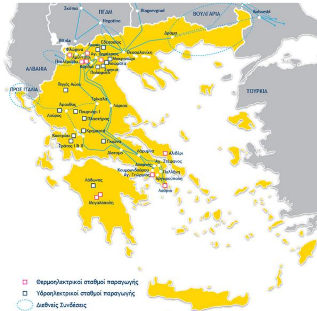
Εικόνα 3.2 Χάρτης διασυνδεδεμένου συστήματος μεταφορές ηλεκτρικής ενέργειας (Πηγή: Διαχειριστής Ελληνικού Συστήματος Μεταφοράς Ηλεκτρικής Ενέργειας Α.Ε)
