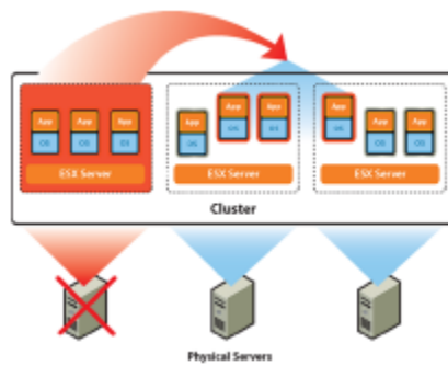
Εικόνα 8.5.2: VMware HA Managing an ESX Host Hardware Failure
