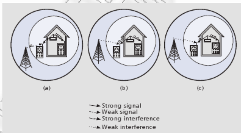
Εικόνα 14: Μηχανισμοί Ελέγχου Πρόσβασης (a) Closed (b) Open (c) Hybrid
