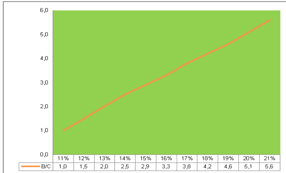
Σχήμα 8.12 Συσχέτιση των δεικτών C.F. και B/C των φωτοβολταϊκών
