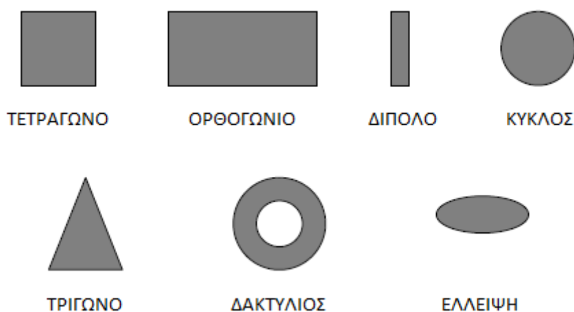
Σχήμα 2.2 Κοινά σχήματα μικροταινιακών στοιχείων
