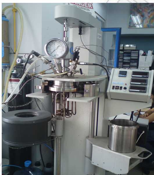
Εικόνα 5-3: Το αυτόκλειστο όπου διακρίνονται το δοχείο, η βάση του δοχείου και ο θερμαντικός μανδύας που περιβάλλει το δοχείο
