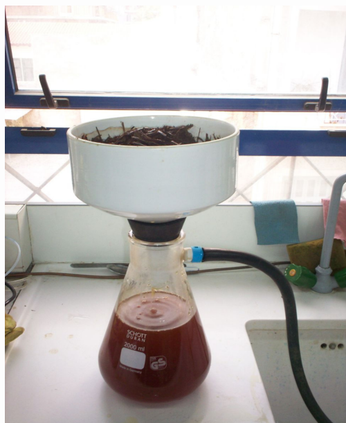
Εικόνα 5-4: Ηθμός Buchner όπου γίνεται η διήθηση του υλικού υπό κενό
