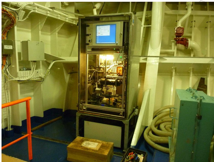
Εικόνα 1.12: Το σύστημα Ferry-Box ( http://www.myocean.eu/web/41-in-situ.php )
