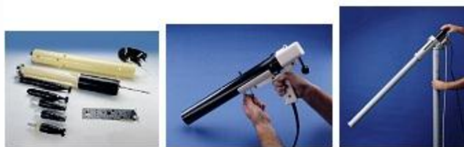
Εικόνα 1.11: Οβίδες XBT και εκτοξευτήρες κινητοί και σταθεροί ( http://www.sippican.com )
