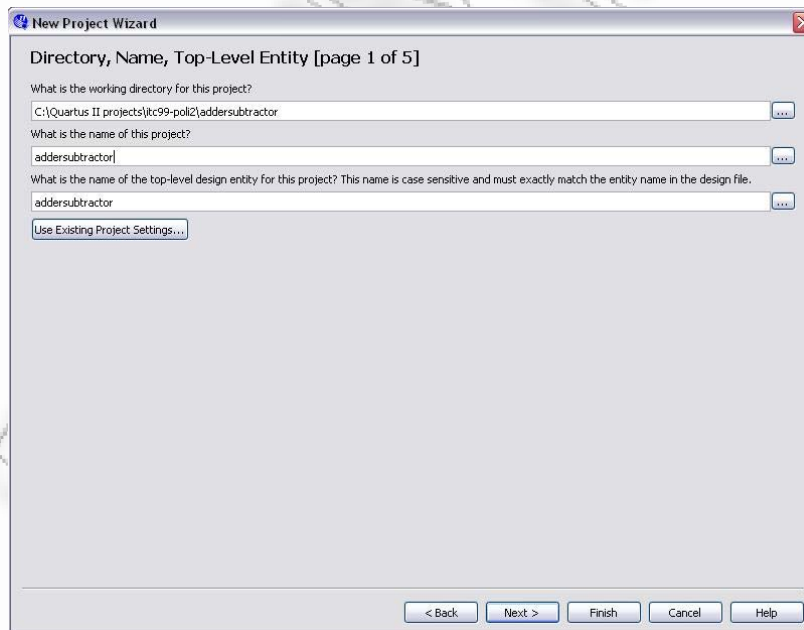
Εικόνα 4.6 Δημιουργία νέου project από το εργαλείο σχεδίασης Quartus II
