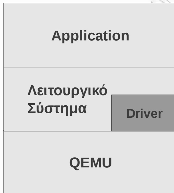
Σχήμα 1.1: Γενική αναπαράσταση της τοποθεσίας του QEMU και της ανάδρασης του με το Λειτουργικό Σύστημα.
