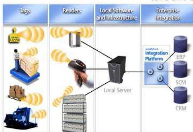
2.2. Βασικά στοιχεία ενός RFID συστήματος [3]
