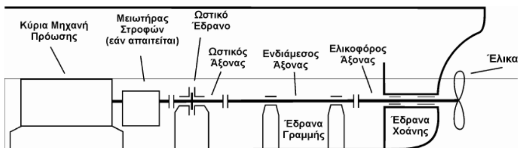
Σχ. 1-3: Τυπική εγκατάσταση πρόωσης
