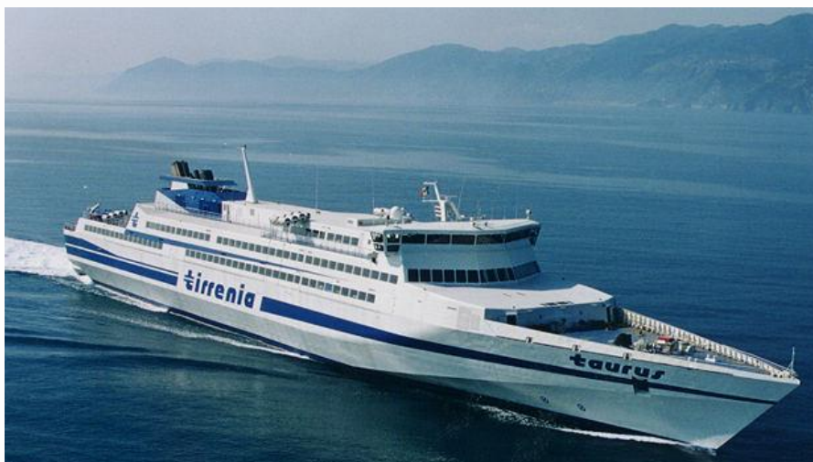
Σχ. 6-7: Ταχύπλοο Επιβατηγό – Οχηματαγωγό μίας γάστρας (monohull) τύπου MDV 3000
