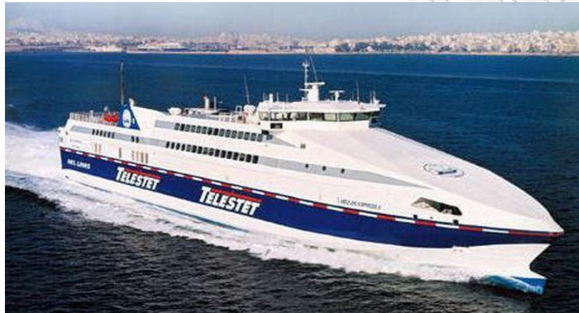
Σχ. 6-6: Ταχύπλοο Επιβατηγό – Οχηματαγωγό μίας γάστρας (monohull) τύπου CORSAIRE 14000
