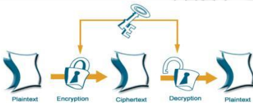
Εικόνα 5. Ένα κλειδί για κρυπτογράφηση και αποκρυπτογράφηση - Συμμετρική Κρυπτογραφία
