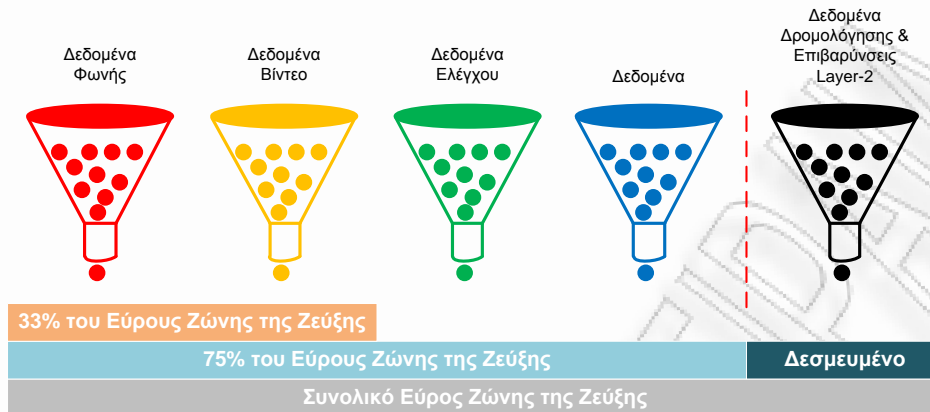
Εικόνα 3-2: Ενδεικτική Κατανομή του Εύρους Ζώνης Βάσει του Τύπου Κίνησης
