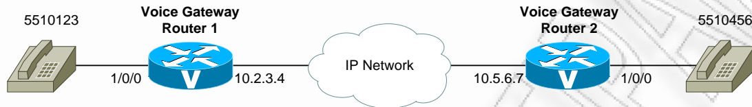
Εικόνα 4-38: Παράδειγμα Δρομολόγησης Κλήσεων Μεταξύ Αναλογικών Τηλεφώνων
