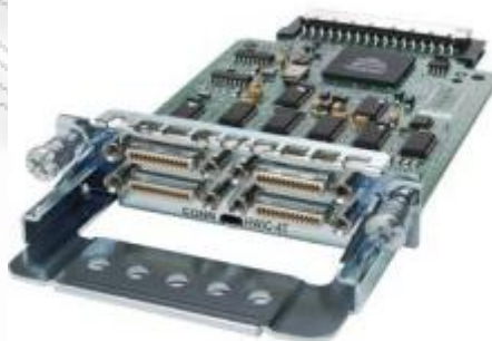
Εικόνα 4-9: Η Κάρτα HWIC-4T για Διασύνδεση Κεντρικού με Υποκαταστήματα Μέσω Μισθωμένων Γραμμών
