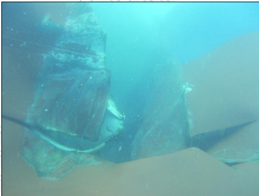
Κατάσταση Πλωριού τμήματος υπό την θάλασσα
