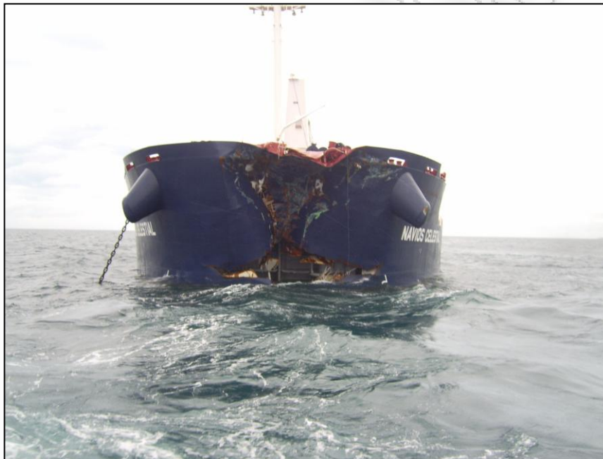
Κατάσταση του πλοίου m/v UNIPI μετά την σύγκρουση
