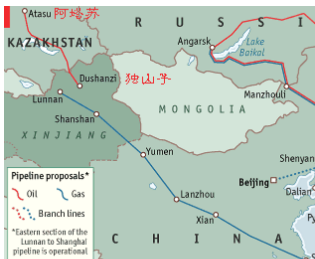
Σχήμα 4.7.(2) Ο αγωγός φυσικού αερίου Καζακστάν-Κίνας, K.C.P.
