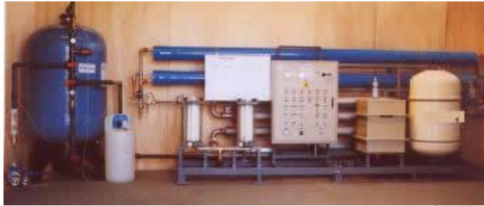
Εικόνα 7 : Σύστημα αντίστροφης όσμωσης για την παραγωγή πόσιμου νερού από εφάλμυρο νερό έως και 7.000 ppm TDS
