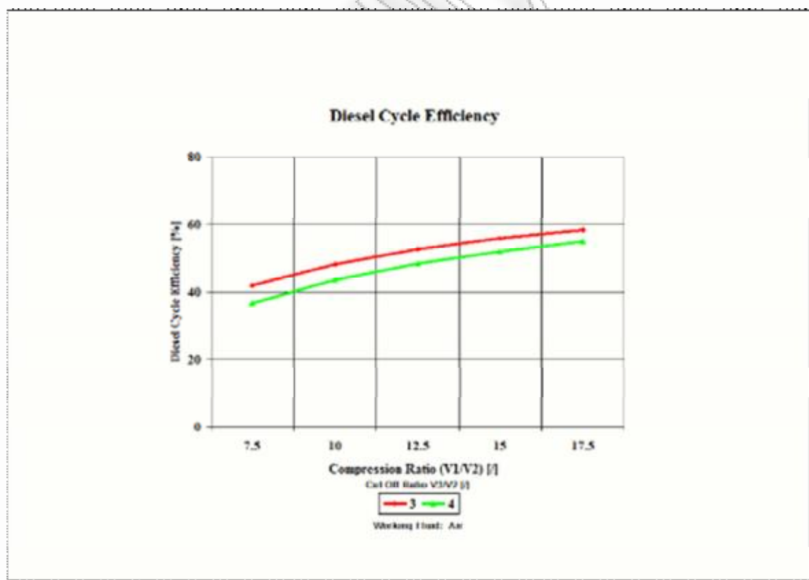
Εικόνα 2.17 Διαγραμματική απεικόνιση συσχέτισης βαθμού απόδοσης με τον λόγο συμπίεσης και λόγο αποκοπής (κύκλος DIESEL).
