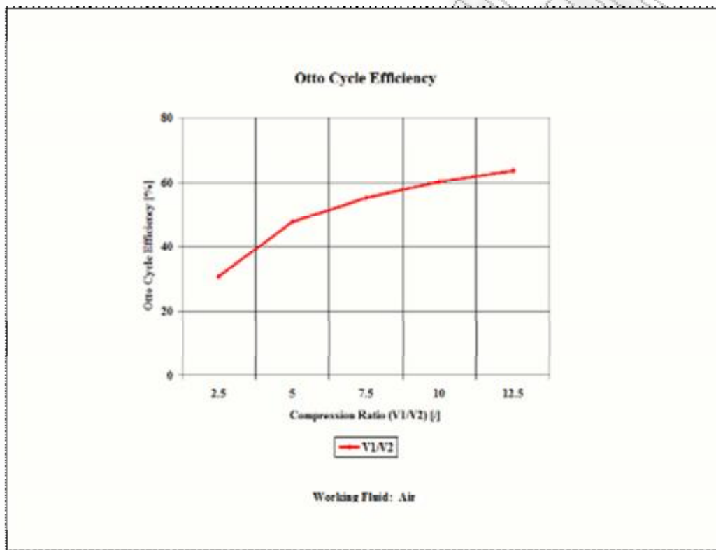
Εικόνα 2.11 Διαγραμματική απεικόνιση συσχέτισης βαθμού απόδοσης με τον λόγο συμπίεσης (κύκλος ΟΤΤΟ)
