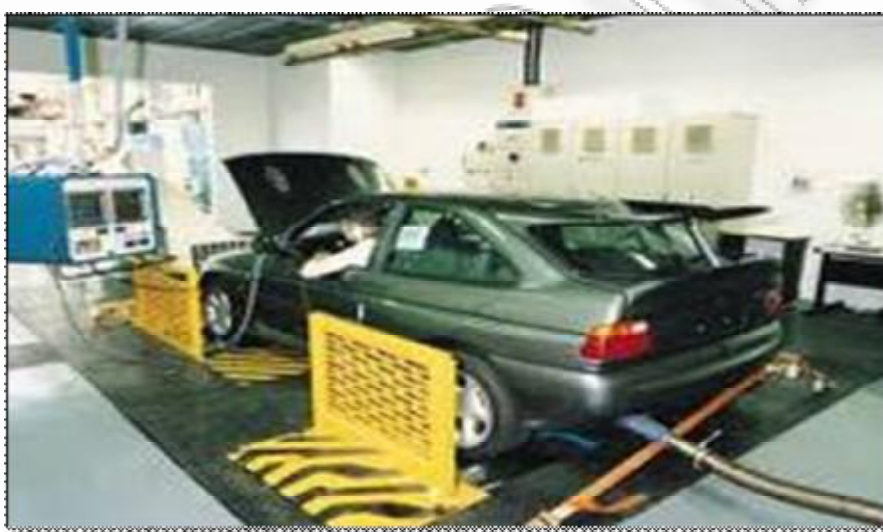
Εικόνα 4.2 Δυναμόμετρο τύπου chassis πραγματοποιεί μέτρηση
