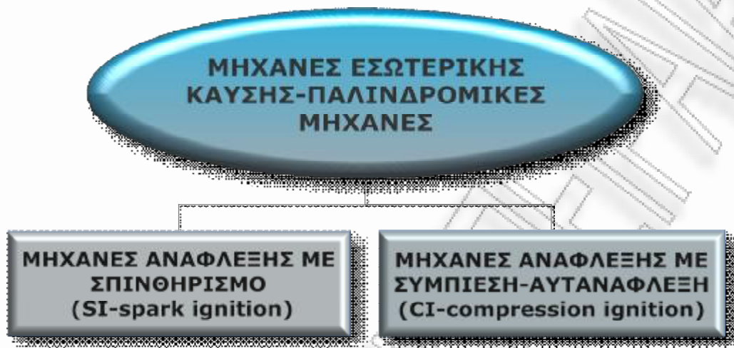
Εικόνα 2.3 Διάκριση παλινδρομικών μηχανών εσωτερικής καύσης
