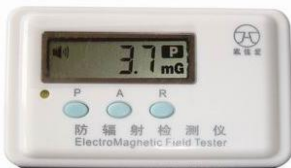
Εικ. 1: Αισθητήρας ηλεκτρομαγνητικής ακτινοβολίας
