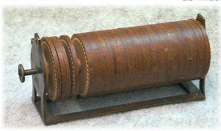
Εικόνα 1.2 Η μηχανή κρυπτογράφησης wheel cipher
