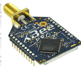
Εικόνα 4: Ένα Xbee PRO με εμβέλεια που φτάνει το 1,5 χιλιόμετρο.
