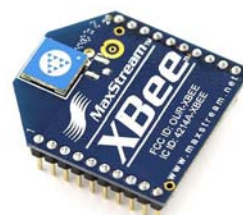
Εικόνα 14: Το ασύρματο module Xbee Series One από την MaxStream.
