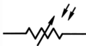
Εικόνα 7: Το ηλεκτρονικό σύμβολο των φωτοαντιστάσεων.
