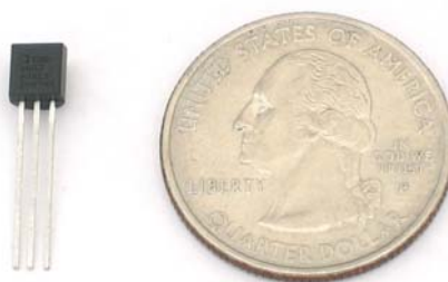
Εικόνα 18: Ο αναλογικός αισθητήρας θερμοκρασίας TMP36.
