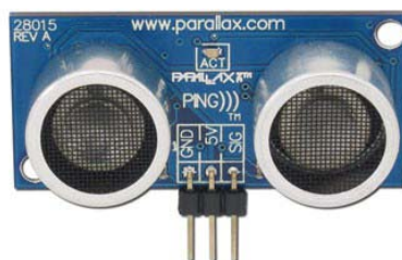
Εικόνα 21: Ο αισθητήρας υπερήχων PING))) που μετράει απόσταση.
