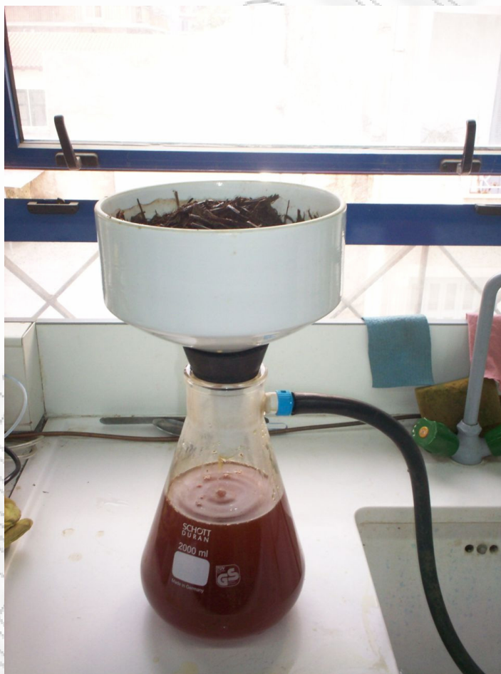
Σχήμα 5.4. Διαχωρισμός της υγρής από τη στερεή φάση του τροποποιημένου λιγνοκυτταρινούχου υλικού σε δοχείο υπό πίεση μέσω ενός ηθμού Buchner
