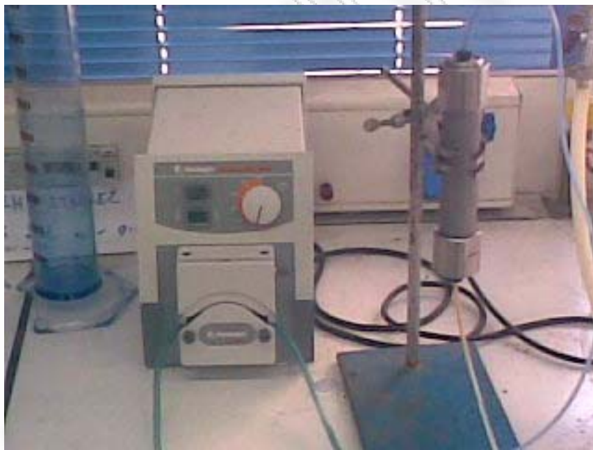
Μεταλλικές στήλες προσρόφησης του Εργαστηρίου Προσομοίωσης Βιομηχανικών Χημικών Διεργασιών του Πανεπιστημίου Πειραιώς
