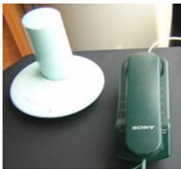
Σχήμα 6: Ένα εσωτερικός δέκτης WiMAX (CPE) τοποθετείται κοντά στο παράθυρο και συνδέεται με το δίκτυο του πελάτη.
