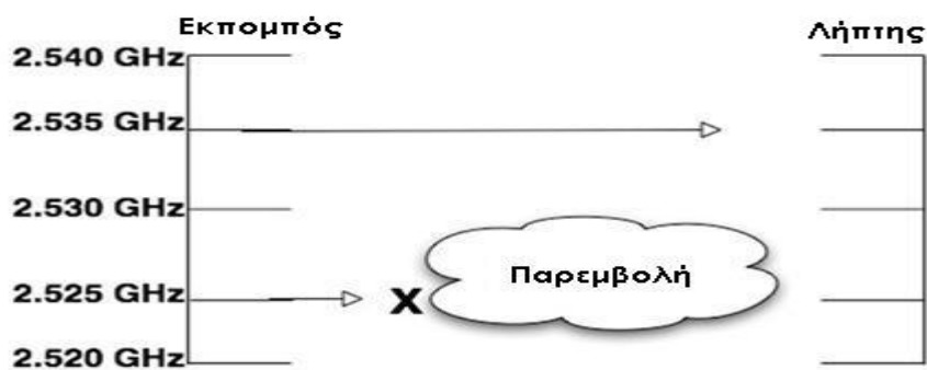
Σχήμα 17: Η δυναμική επιλογή συχνότητας επιτρέπει σε ένα ράδιο να αλλάζει συχνότητες όταν υπάρχουν παρεμβολές στην συχνότητα λειτουργίας.
