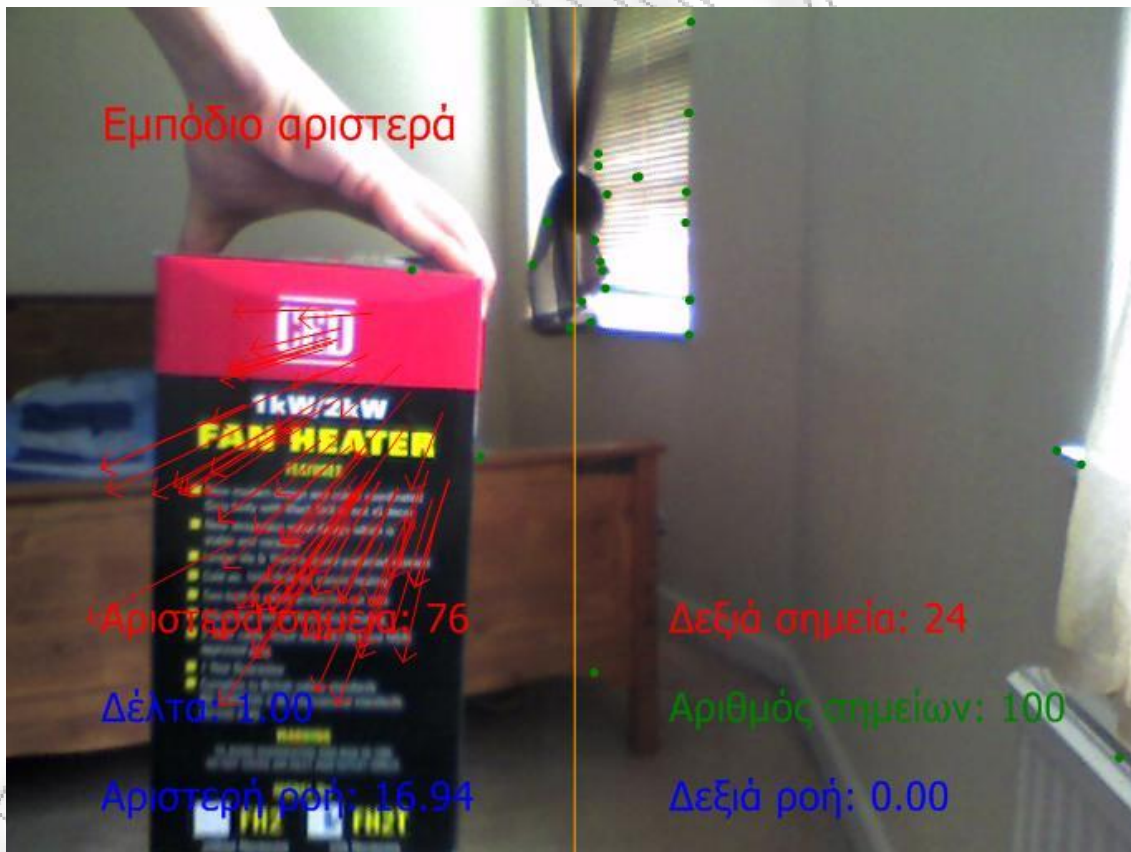
Εικόνα 3-14: Παράδειγμα λειτουργίας του αλγορίθμου, όταν υπάρχει εμπόδιο στα αριστερά. Τα πράσινα σημεία είναι εκείνα που δεν παρουσίασαν σημαντική κίνηση, ενώ τα κόκκινα βέλη δείχνουν την κίνηση των σημείων σε δύο διαδοχικές εικόνες.
