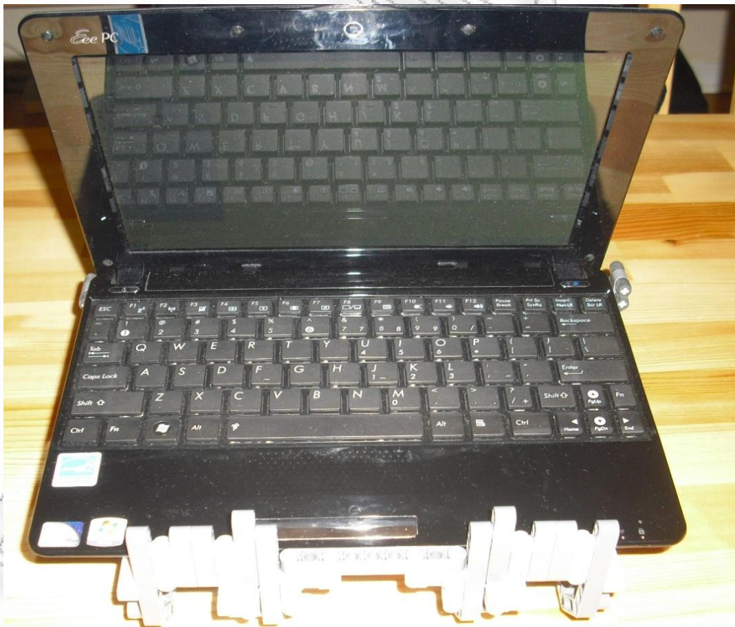
Εικόνα 3-7: Η μπροστινή όψη του ρομπότ με τον υπολογιστή προσαρμοσμένο στην βάση του.
