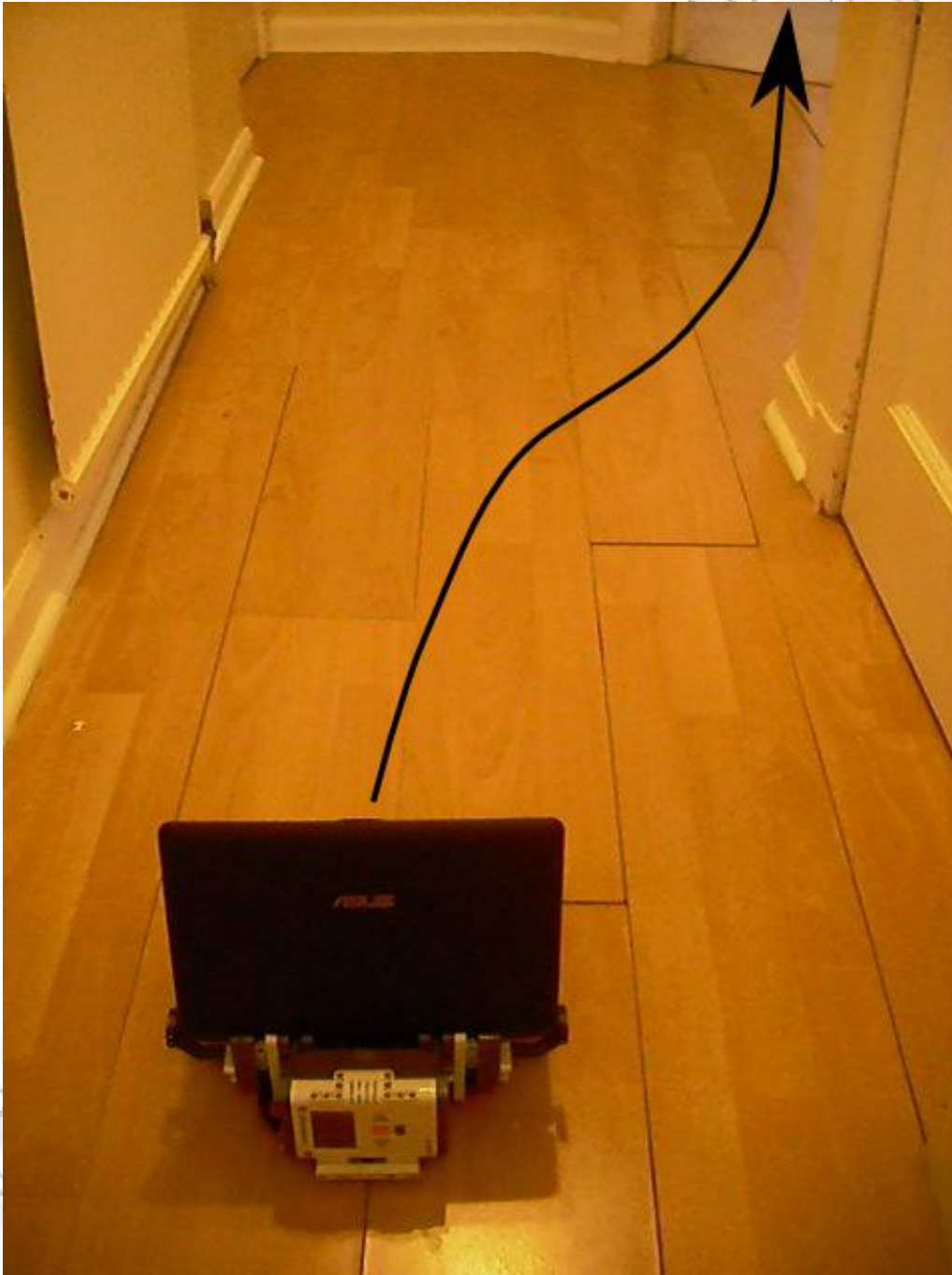
Εικόνα 4-16: Το μονοπάτι που ακολούθησε το ρομπότ για να πλοηγηθεί στον διάδρομο
