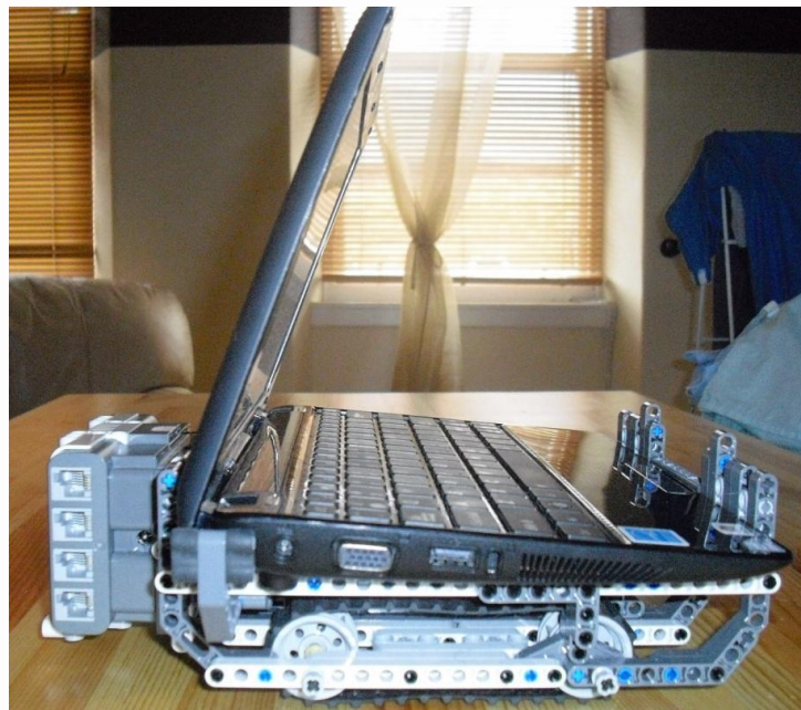
Εικόνα 3-8: Η πλαϊνή όψη του ρομπότ με τον υπολογιστή προσαρμοσμένο στην βάση του.
