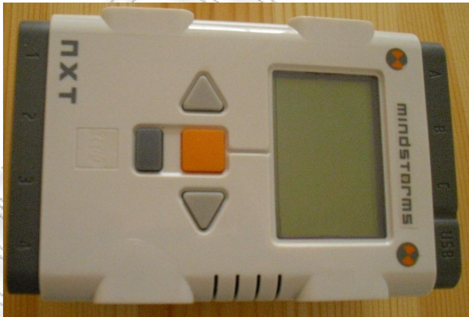
Εικόνα 3-1: Η υπολογιστική μονάδα του LEGO NXT.
