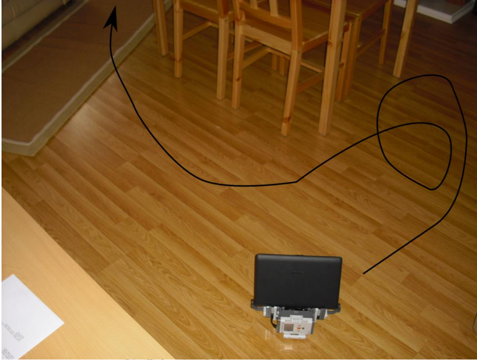
Εικόνα 4-21: Το μονοπάτι που ακολούθησε το ρομπότ για να πλοηγηθεί στον χώρο
