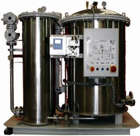
Το σύστημα διαχωρισμού Πετρελαίου - Νερού POSEIDON EVO της ΤΠΠ.
