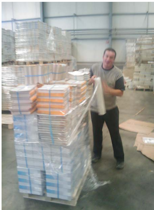
Εικόνα 7: Μη αυτοματοποιημένη συσκευασία παλέτας
