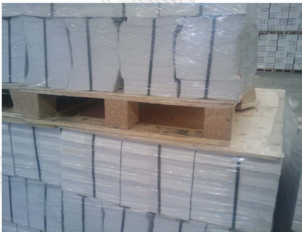
Εικόνα 5: Παραμόρφωση δεμάτων από στίβαξη παλετών
