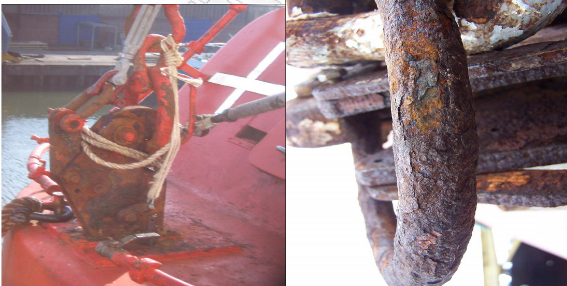
Εικόνα 6-3-5-1: Γάντζοι με εμφανή σημάδια φθοράς
