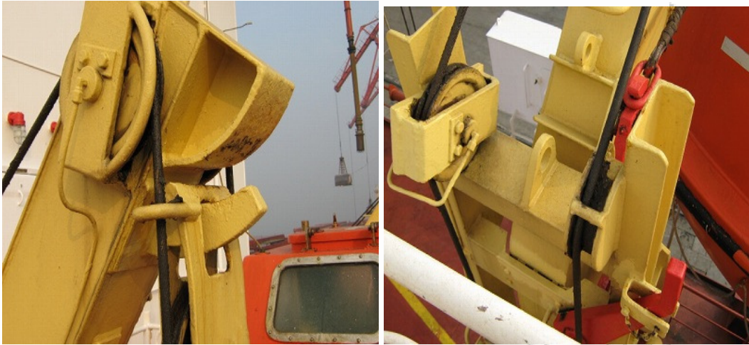
Εικόνες 4-1-4. Davit horn, sheaves assembly, arm stopper and trigger hook.
