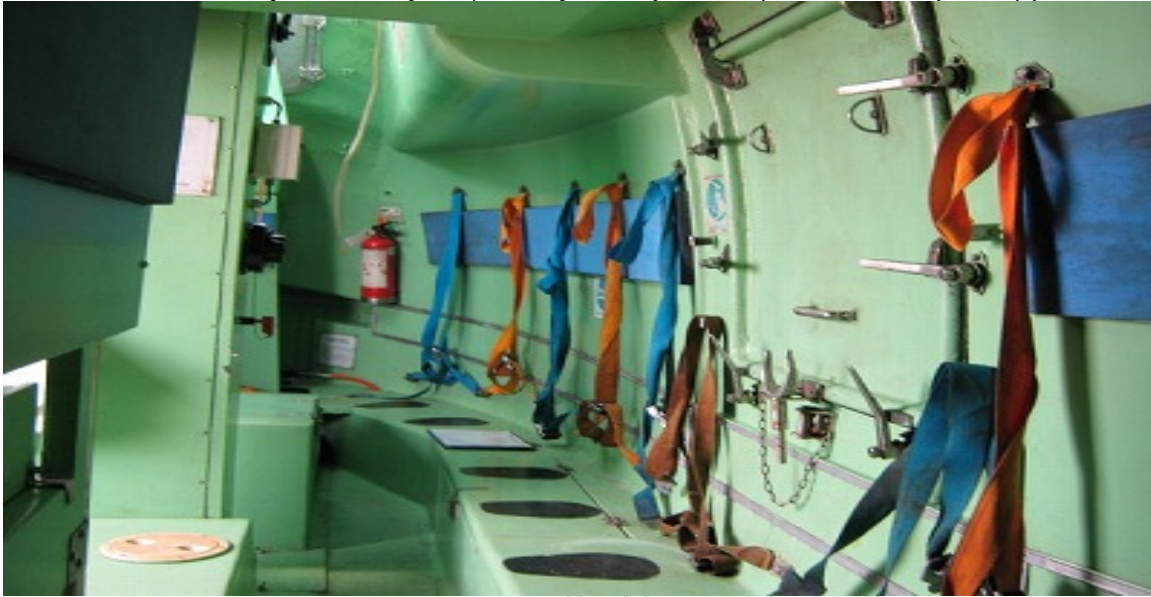
Εικόνα 5-1-1: Θέσεις και Ζώνες Ασφαλείας (Safety Belts) μέσα σε σωσίβια λέμβο.
