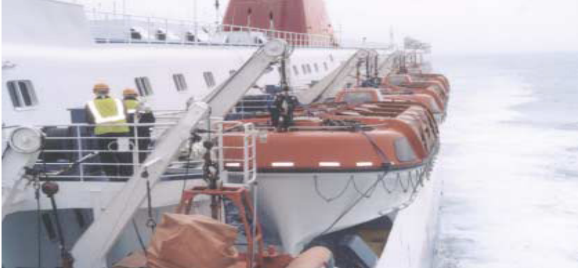
Εικόνα 2-1 Κλασική διάταξη Σωσίβιας Λέμβου και Συστήματος Καθαίρεσης
