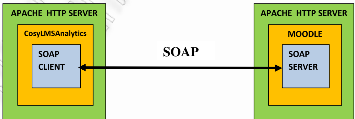
Σχήμα 4.4 - Ο SOAP SERVER και η WSDL περιγραφή είναι στο ίδιο υπολογιστικό σύστημα.
