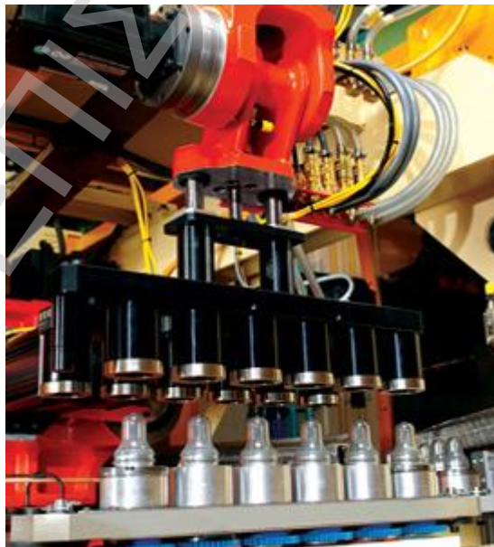
Φωτογραφία 13: Μεταφορά preforms για θέρμανση
