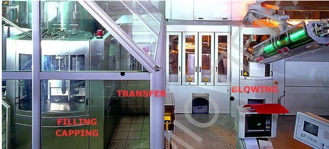
Φωτογραφία 17: Εμφιάλωση και Πωματισμός
