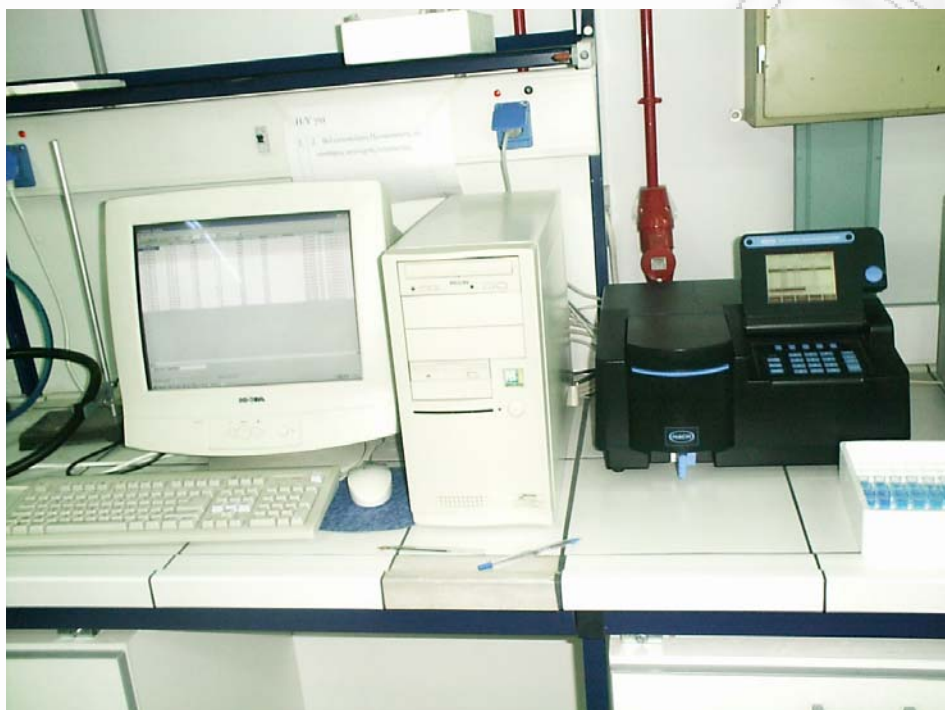
Σχήμα 7.1. Φασματοφωτόμετρο UV-VIS τύπου HACH 1 στο Εργαστήριο Προσομοίωσης Βιομηχανικών Διεργασιών του τμήματος Βιομηχανικής Διοίκησης και Τεχνολογίας του Πανεπιστημίου Πειραιά.
