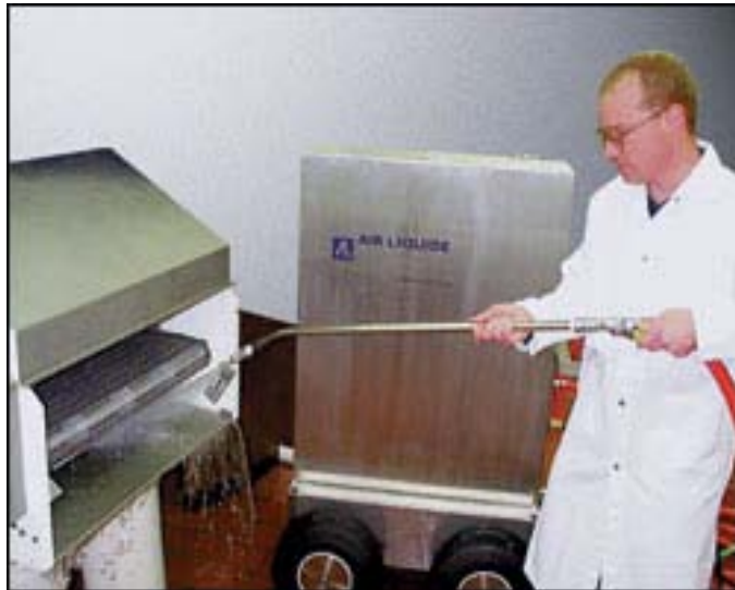
Εικόνα 2.1: Χειρονακτικός καθαρισμός μεμβρανών με χρήση νερού υπό πίεση
