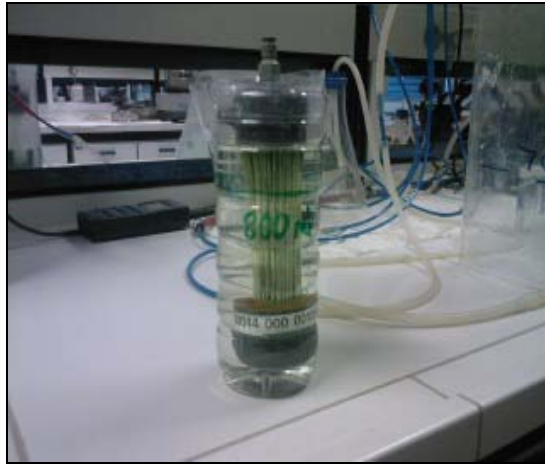
Εικόνα 6.16: Καθαρισμός μεμβράνης με υποχλωριώδες νάτριο.
