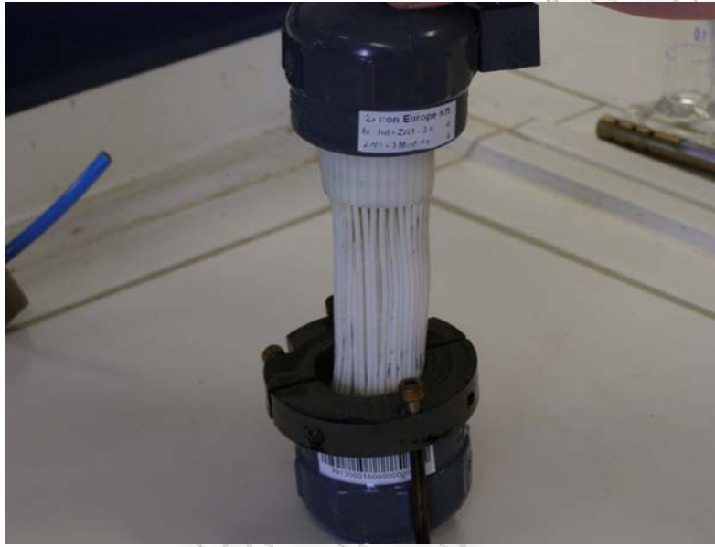
Εικόνα 6.9: Μονάδα μεμβρανών υπερδιήθησης που χρησιμοποιήθηκε στα πειράματα
