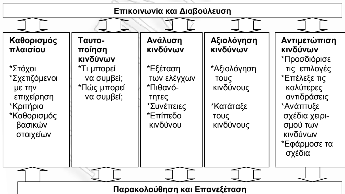
Διάγραμμα 1.7: Διεργασία Διαχείρισης Κινδύνου κατά AS/NZS 4360:2004 Πηγή: Broadleaf Capital International Pty Ltd, The Australian and New Zealand Standard on Risk Management, AS/NZS 4360:2004, 2007
