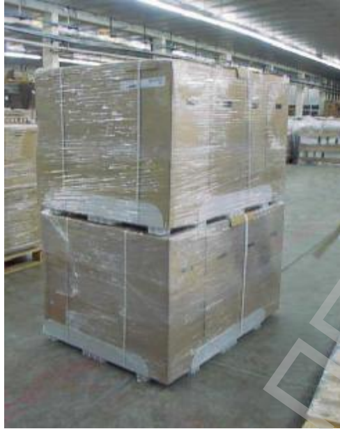
Σχήμα 39. Παλετοποίηση με χρήση Loading Ledge [2.26]
